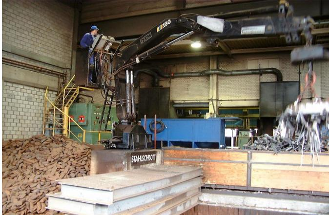
► Das Alteisen, das Roheisen und der Stahlschrott werden per Kran zum Ofen geführt.
