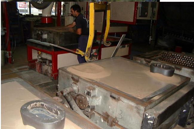
Bei der Vakuumformmaschine bleibt die Form unter Vakuum bis sie ausgegossen ist.
