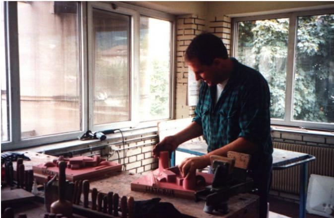
► Herr Spadin poliert das fertige Modell, auf die rosarote Grundierung wird anschliessend die rote Modellfarbe aufgetragen.
