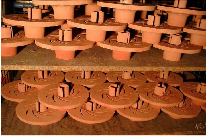
► Gestapelte Kerne bereit zum einlegen. Diese Kerne entsprechen dem Innenraum von kleinen Turbinenrädern. Das heisst, sie werden nach dem Giessen zerstört und fallen aus dem Gussstück heraus. Zurück bleibt der Hohlraum.
