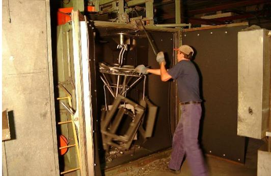
► Herr Lekic Dragan zieht den Strahlkorb aus der Strahlkabine. Unten befinden sich 233 Rahmen und oben kleinere Gusstücke. Der Strahlkorb ist mit Rollen an einer Schiene aufgehängt und dient nun auch noch weiter als Transportmittel bis in die Putzerei.
