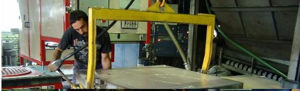
► Der Modellplattenträger der automatischen Formanlage ist ein Drehteller, so dass der Former beide Modellteile an einem Ort formen kann. An der Automatischen Formmaschine arbeitet nur ein Mann, viele Arbeitsschritte werden von der Maschine ausgeführt. Herr Albrecht gibt hier der Oberteilform *den letzten Strich*. Im Vordergrund sieht man die Unterteilsandform für einen 235-er Strassenrost. ◀
