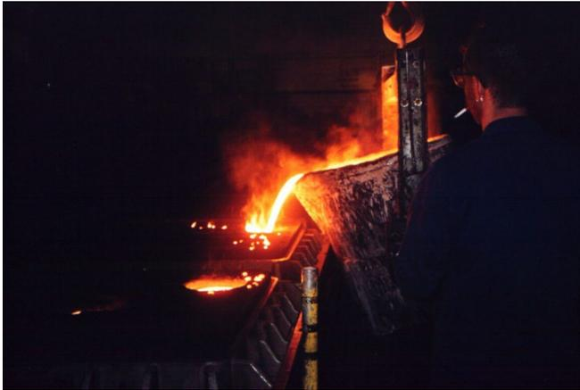
▼ Die Giesspfanne wird mit einem Handrad bedient. Der Giesser muss das Austreten des flüssigen Eisens durch den Abluftkanal genau im Auge behalten, damit er die Form nicht zum Überlaufen bringt. ◀
