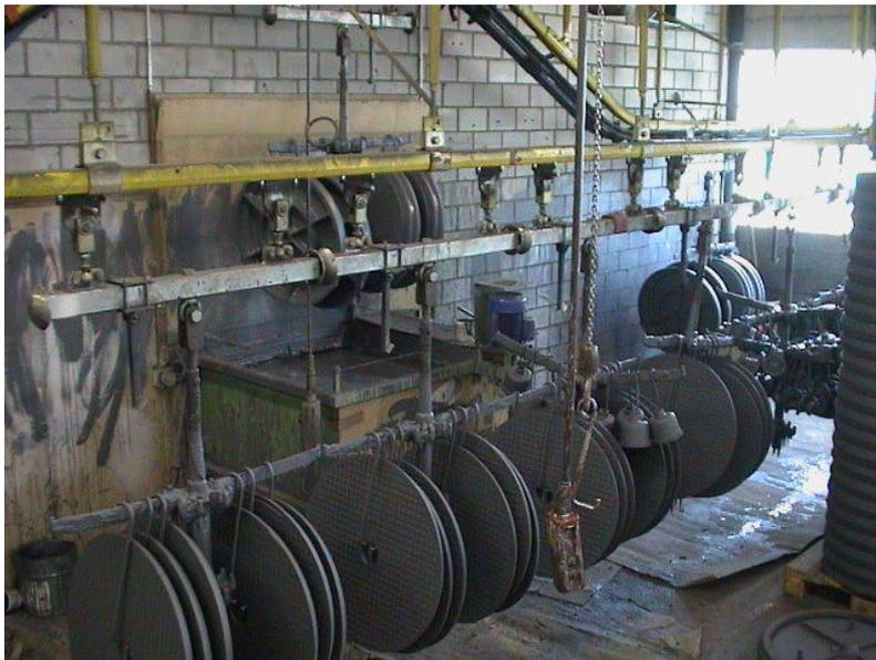
► Im Tauchbad werden die Gussstücke mit Rostschutzfarbe versehen. Schon nach kurzer Zeit können die Stücke im Vordergrund abgenommen werden. Das behandelte Gusstück ist nun fertiggestellt und wird für den Versand gerüstet.
