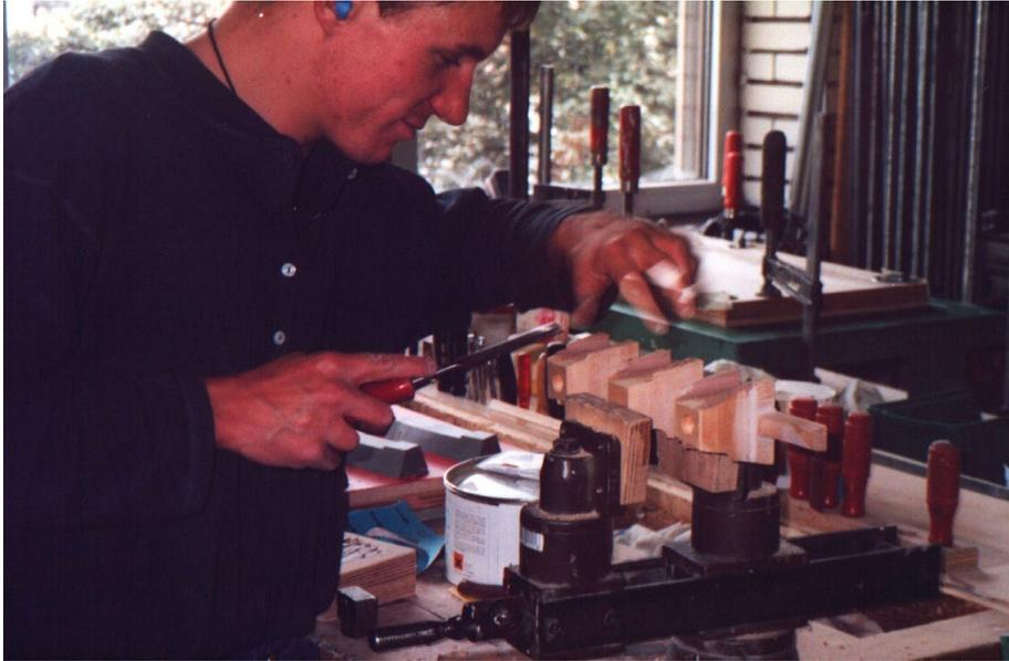
▼ Rinaldo bei der Erstellung einer Reihe von Eingusssteigern. Die Steiger werden aus Erlenholz und Kunststoff gefertigt und, wo nicht anders möglich, von Hand gefeilt und geschliffen.
