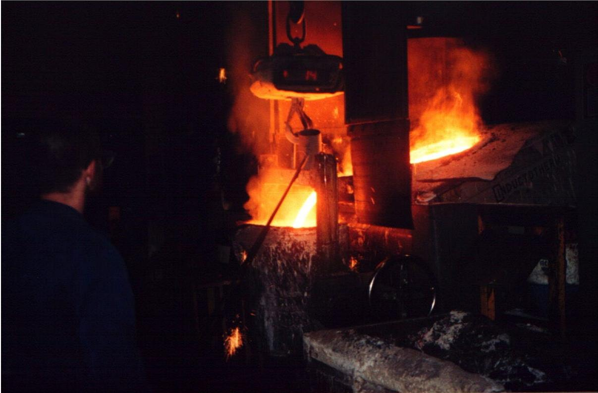
▼ Das Vergiessen des flüssigen Eisens in die Giesspfanne nennt sich Ofenabstich. Die Pfanne hängt an einer Waage, so dass der Giesser immer über eine Gewichtsangabe verfügt.
