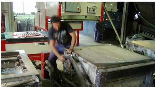
► Beim Verschliessen der Form wird das Kastenoberteil auf das Kastenunterteil gelegt. Die beiden Teile werden durch Präzisionsführungen vor gegenseitiger Verschiebung geschützt und durch eine Schliessvorrichtung zusammengehalten, um dem Auftrieb des Eisens Stand zu halten.
