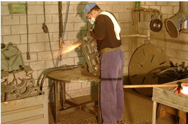
► Herr Gönek Hidir verputzt ein Gussstück. Mit der Handschleifmaschine werden unzugängliche Partien geschliffen.
