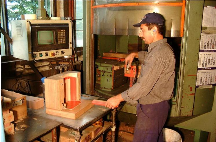
► Herr Okay reinigt und präpariert eine Kernbüchse zum Schuss. Hinter ihm befindet sich die Kernschliessmaschine. Links ist eine Klemmbanke sichtbar, mit deren Hilfe die Kernbüchse fixiert wird. Der Sandeinschuss findet dann von oben statt. Die Überwachung und Manipulation der Anlage erfolgt über den Bildschirm links im Bild.
